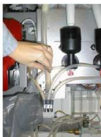
Снять силиконовые трубки, выводящие напитки, и соответствующие подставки. Опустить все части в раствор.
